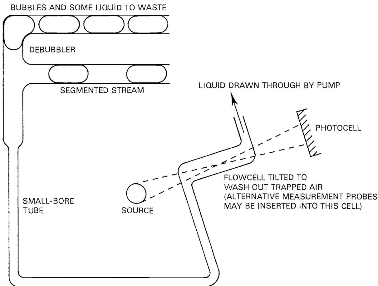
FIG 22 PHASE SEPARATION
