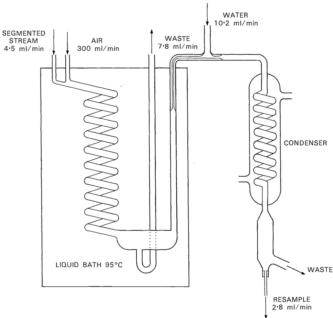
FIG 20 DISTILLATION UNIT
